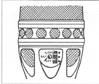
Vérification de la pile
